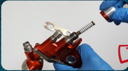
Démonter d'abord l'aiguille
