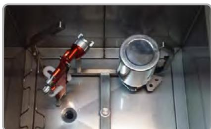
*On peut mettre jusqu'à deux pistolets dans le tank.*
