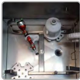
On peut mettre jusqu'à deux pistolets dans le tank.
